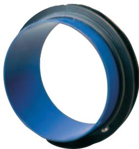
Bei der Durchführung von Stahl-, Gußeisen-, Kupfer-, Kunststoff-, Faserzement-, Beton- und Steinzeugrohren durch Wände, Decken, Fußböden, Schachteinführungen, Schwimmbäder und Grundwasserwannen, sind PSI-Mauerkragen das richtige Zubehör, um diese Rohre hydrostatisch abzudichten.
